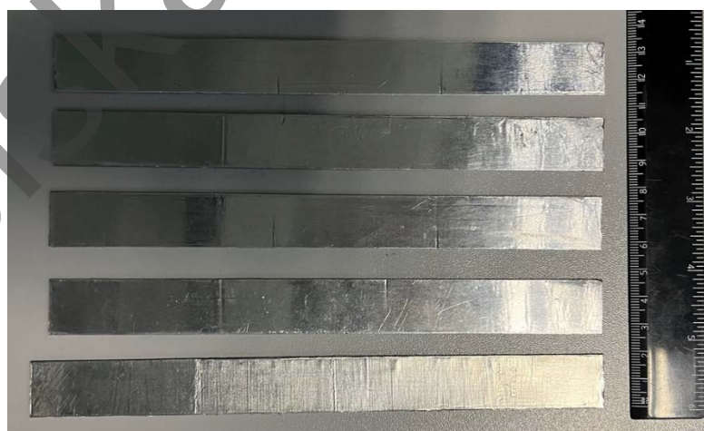
Рис.2. Образцы для испытания. а) образцы без демпфирующих слоев; б) образцы с приклеенными слоями демпфирующего материала.
